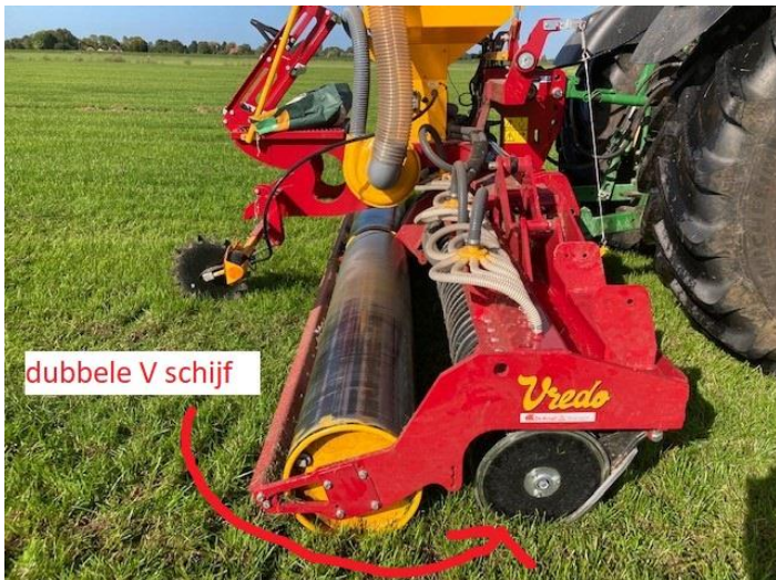
Foto 1: Vredo heeft bewezen doorzaai techniek. Dubbele V vormige schijven brengen het zaaizaad in de grond. Dit bevordert een snelle kieming en opkomst.
