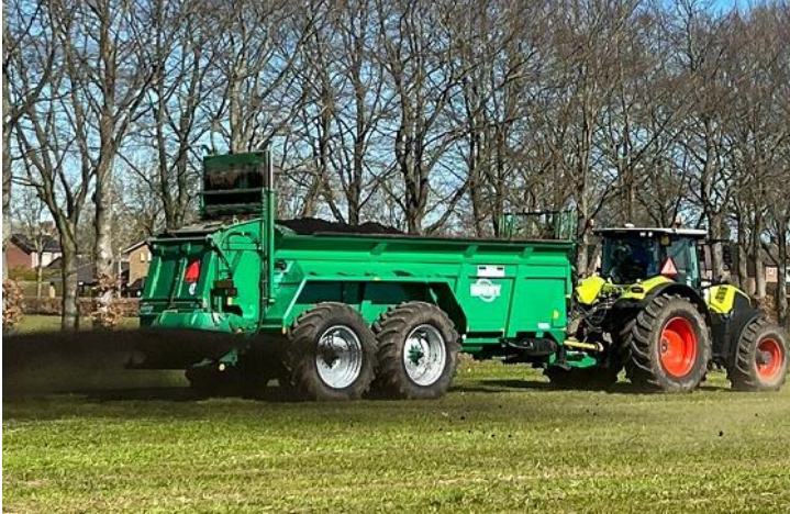
Foto 4 Onze moderne Tebbe strooier heeft een inhoud van 20 m 3 en is uitgerust met:
